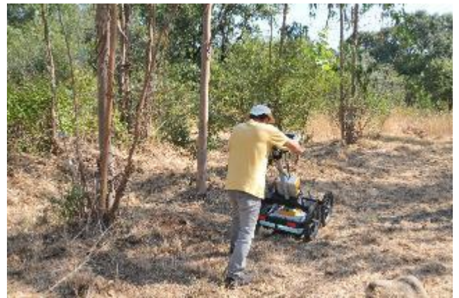
Figura 6 – Passagem do GPR nas linhas Longitudinais do Sítio Rego da Murta III. Foto: Daivisson Santos.
