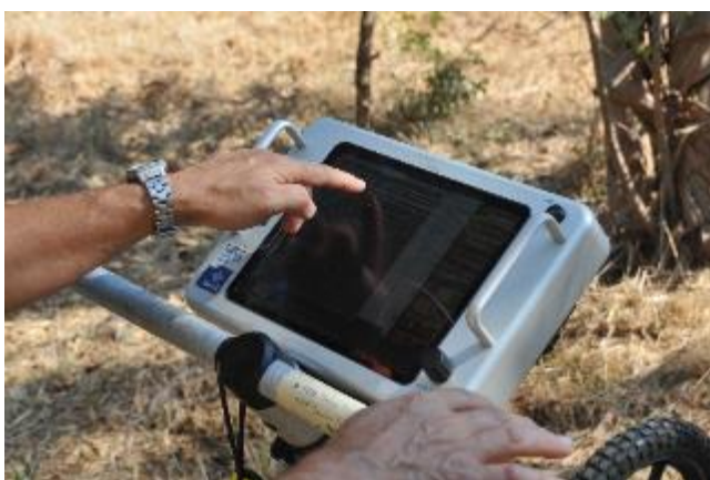
Figura 7 – Leitura de dados do GPR em campo. Foto: Daivisson Santos
